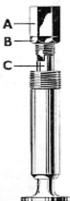
S.V. Tappet Adjustment Fig. 4.
